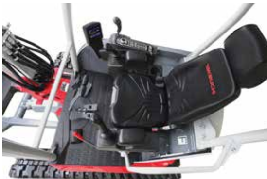
Comandi: computer di bordo, Jog-Dial, manipolatori, fari, lampeggiante, modalità Eco, funzionamento a scatto, leva lama dozer, quadro di accensione.
