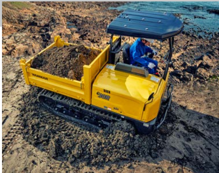
Manovra di contro-rotazione con movimento inverso dei cingoli
