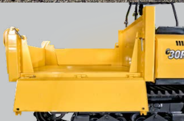
Cassone con sponde apribili su tre lati con scarico sul retro
