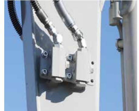
Rubinetti all'uscita dell'impianto ausiliario per evitare spillamenti e perdite di pressione in fase di attacco/ stacco delle attrezzature.
