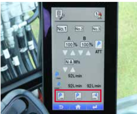
La funzione di Auto Tank permette di impostare il flusso unidirezionale (martello) o bidirezionale (pinza) sul 1°AUX.
