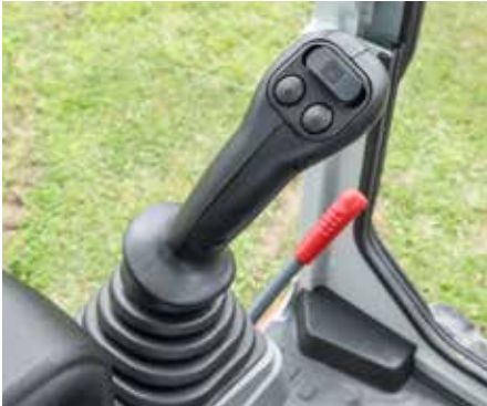
Manipolatore sinistro con comando ausiliario proporzionale e Detent Mode del 1° AUX di serie.
