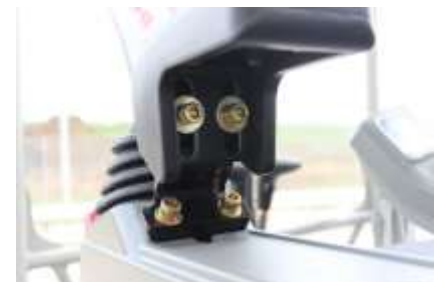
Braccioli regolabili mediante viti di registrazione.
