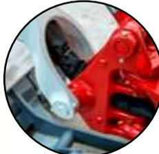
Le tubazioni idrauliche passano all'interno del braccio per ridurre il rischio di rotture causate da detriti o nelle operazioni in aree molto strette.
