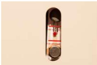
Controllo del livello olio idraulico e del livello gasolio. Vano protetto da chiave contro gli atti vandalici.
