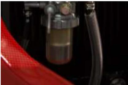
Il decantatore, permette di eliminare l'acqua presente all'interno del serbatoio carburante.
