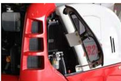
Botola laterale garantisce un comodo accesso per la pulizia del radiatore, del riempimento serbatoio olio idraulico e liquido refrigerante.
