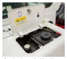
Sostituzione olio idraulico ogni 4.000 h
