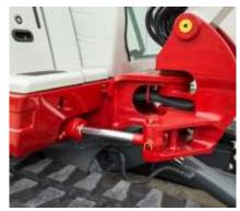
Punti di ingrassaggio Colorati in giallo. Le valvole sono sempre protette per evitare rotture.
