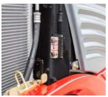
Punto di controllo livello olio idraulico
