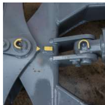
Punti di ingrassaggio protetti e ben visibili.
