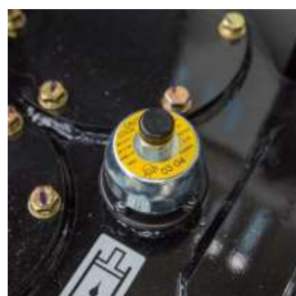
Sfiato serbatoio idraulico
