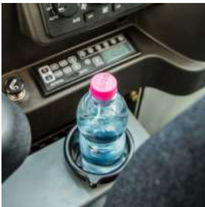
Porta bevande con riscaldamento o raffreddamento integrato, con la rotazione della ghiera è possibile regolare il flusso di aria.
