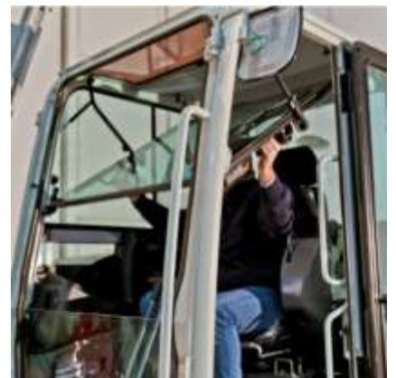
Vetro frontale apribile a scomparsa. Vetro inferiore removibile con supporto dietro al sedile.
