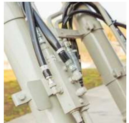
Valvole di sicurezza anticaduta su braccio e avambraccio con allarme di sovraccarico attivabile in cabina.
