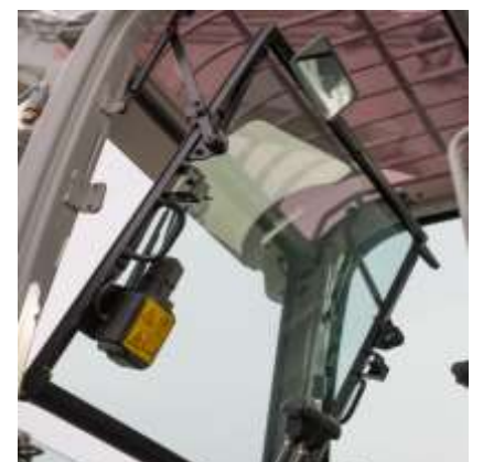
Vetro frontale con apertura a scomparsa. Vetro inferiore removibile con supporto dietro al sedile.
