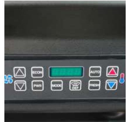
Aria condizionata con pannello di controllo e regolazione automatica della temperatura interno cabina.
