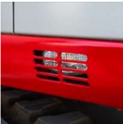
Fari da lavoro a Led per facilitare le operazioni di scavo in condizioni di scarsa visibilità:
