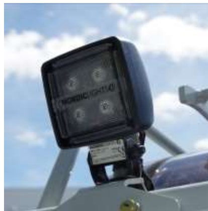
Fari da lavoro a Led per facilitare le operazioni di scavo in condizioni di scarsa visibilità:
