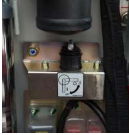
Staccabatteria nel vano motore.
