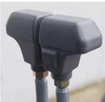
Comando di selezione velocità su leva di traslazione destra.
