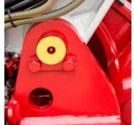
Punti di ingrassaggio ben visibili colorati in giallo. Sistema meccanico di blocco del braccio quando tutto a sinistra. Sistema di recupero del gioco dei perni del brandeggio.
