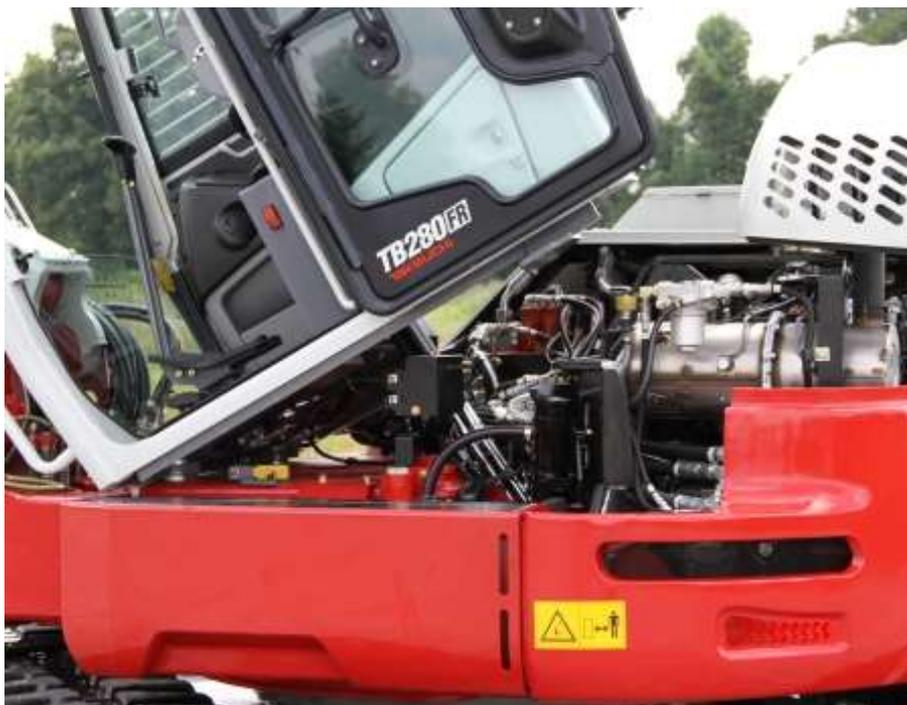
Facile accesso a tutti i componenti grazie alla cabina ribaltabile con ammortizzatori a gas. Manutenzione ad altezza d'uomo.
