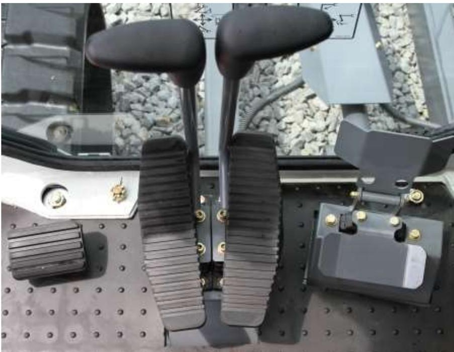
Pedali brandeggio/braccio posizionario con protezione anti azionamento involontario.
