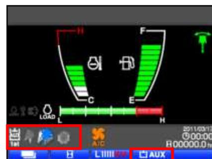
Le configurazioni memorizzate sono richiamabili rapidamente dal menu iniziale premendo il tasto AUX. Selezionando il simbolo scelto, il sistema darà la portata di olio precedentemente memorizzata (di default: No.1 100%; No.2 75%; No.3 50%).
