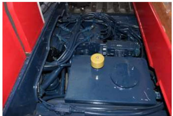
Serbatoio idraulico. Cambio olio idraulico previsto ogni 1.000 ore.
