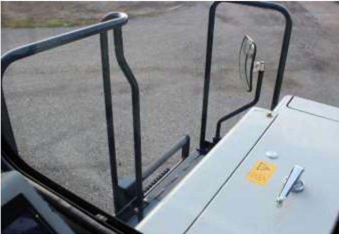
Camminamento per ispezione motore e macchina.
