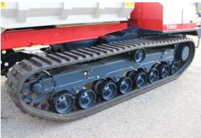
Sistema tendicingolo automatico. Punti di ingrassaggio evidenziati in giallo.
