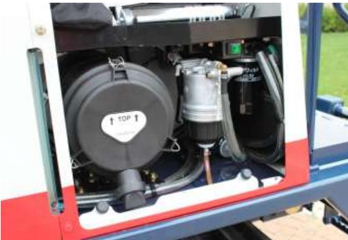
Filtro dell'aria e filtro gasolio doppio elemento con accesso facilitato da un comodo vano sul lato macchina. Manutenzione ad altezza d'uomo.
