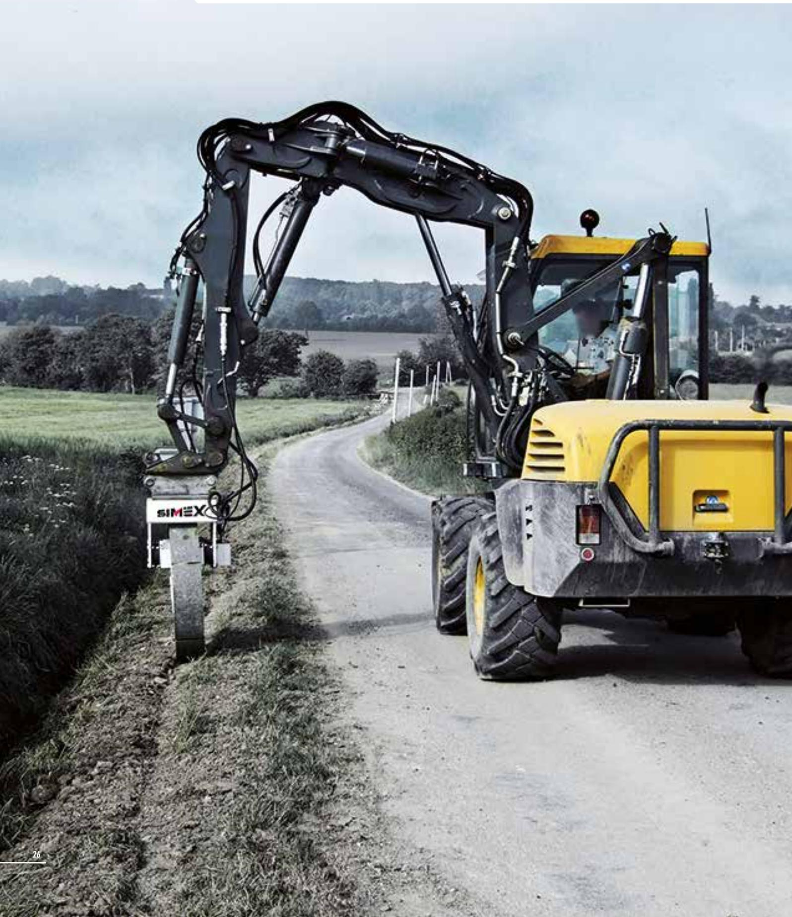
■ Progettati per **compattare il fondo degli scavi in sezione**, i compattatori vibranti a ruota Simex CT, garantiscono un **fondo solido, omogeneo e ben compattato, che non cede nel tempo** e consente la massima sicurezza nella circolazione stradale.
