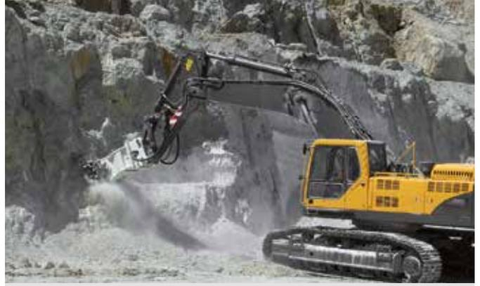
■ Le teste fresanti Simex TF sono ideali per lavori di canalizzazione, profilatura di pareti in roccia e cemento, scavo di gallerie, coltivazioni in cava, demolizioni, dragaggi e lavori di finitura.
