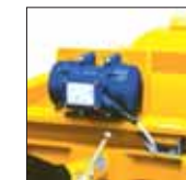
Il vibratore assicura una vagliatura rapida ed efficace
